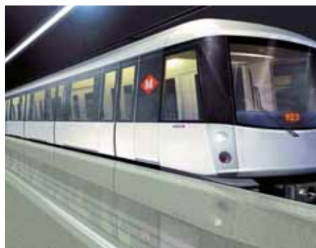
Snart kan man se førerløse tog bygget af aluminiumprofiler i Barcelonas tunnelbane.
