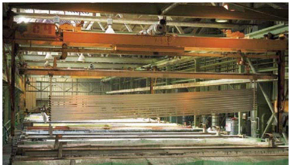
Anodisierung in Alufinals Presswerk in Ziar nad Hronom
