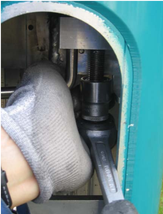
Afb. 17 Draai vervolgens de borgbout met gereedschap (SW-24 mm) vast.
