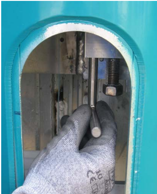
Afb.05 Door de pen naar beneden te trekken wordt de kantelmast ontgrendeld.
