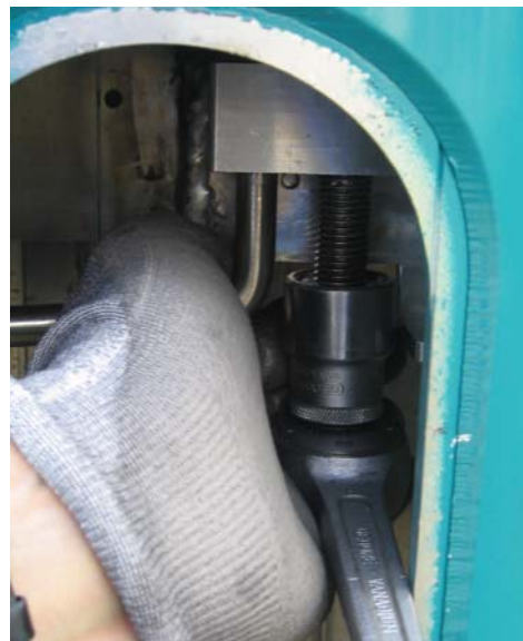
Afb.04 Draai de borgbout met gereedschap los (SW-24) zodat deze vrij op de ondersteuning ligt.
