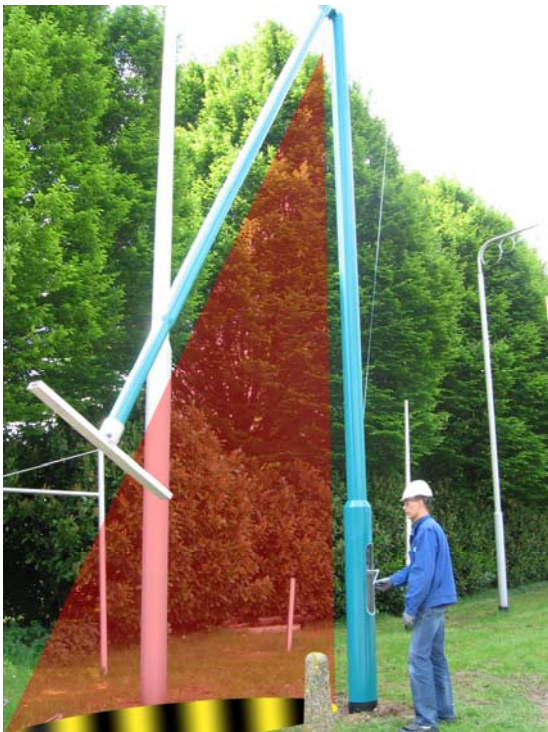
Afb.11 Let op: Tijdens het bedienen is het verboden om tussen de arm en de mast te gaan staan.
