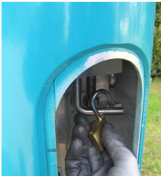
Afb.03 Verwijder het hangslot en draai de borgpen naar links.
