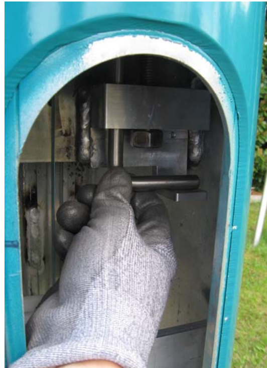
Afb. 18 Draai de hendel van de borgpen naar rechts zodat deze op de nok ligt.
