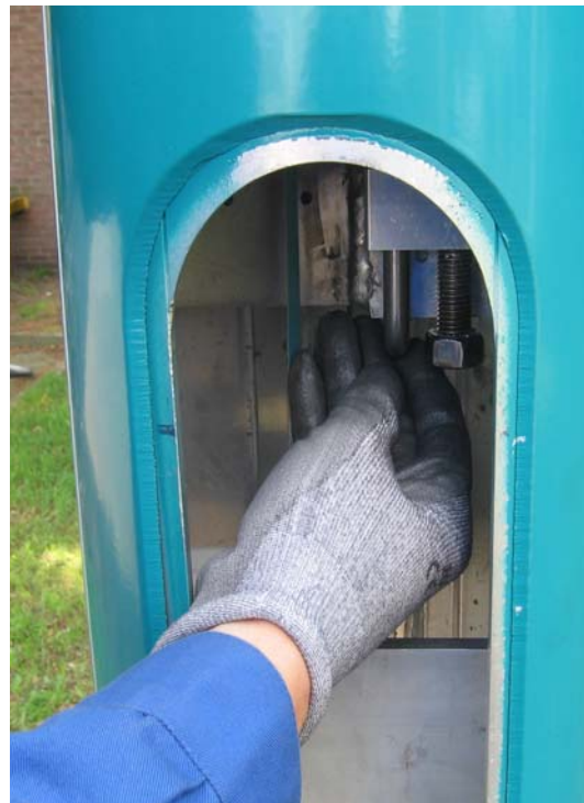
Afb. 16 Vergrendel de mast door de pen omhoog te duwen. Draai de hendel van de pen naar links.
